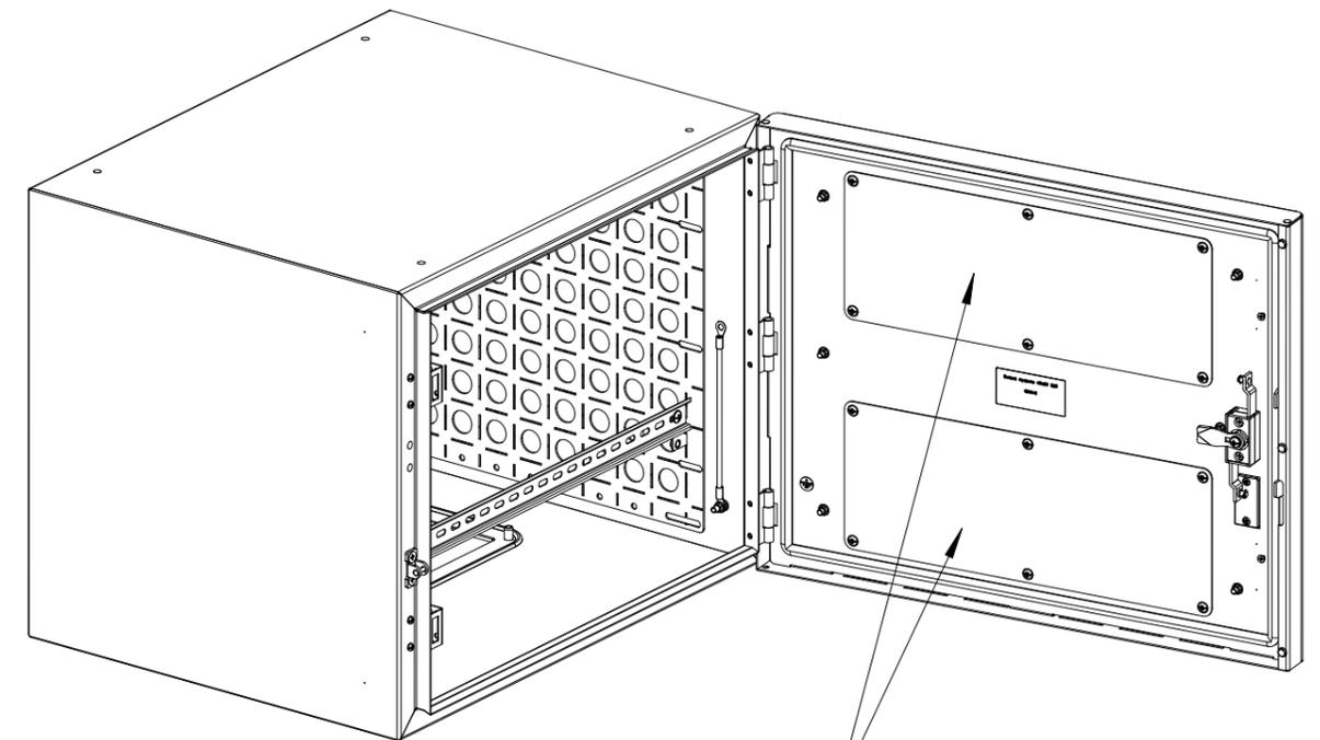
Для установки вентилятора и/или фильтра
